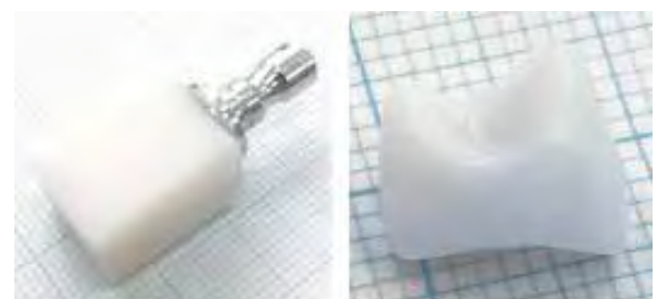
図4 新規CAD/CAMブロックとそれから削り出したクラウン
